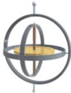
Figure 1: Schéma de principe d'un gyroscope (Animation: http://fr.wikipedia.org/wiki/Gyroscope ).
